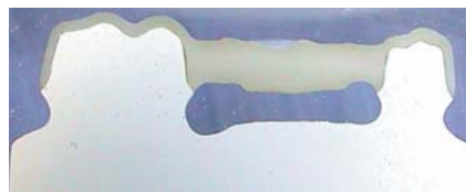
Abb. 5.23: Lichtmikroskopische Aufnahme: Schnitt durch eine 3-gliedrige Brücke von 35 nach 37
