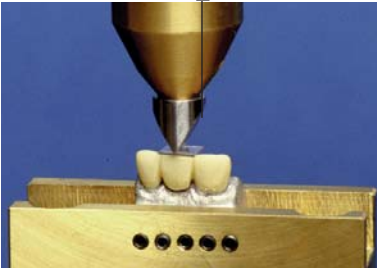
Abb. 5.14: Messung der statischen Bruchlast
